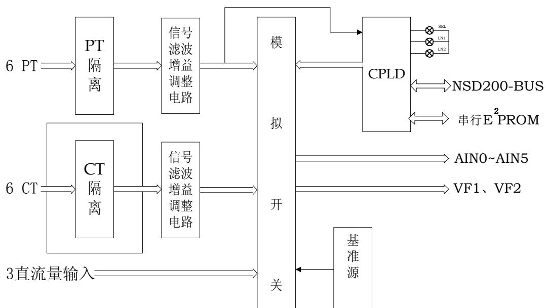
图 3.9 NSD200 系列通用测控装置 AC2A 模块原理框图
