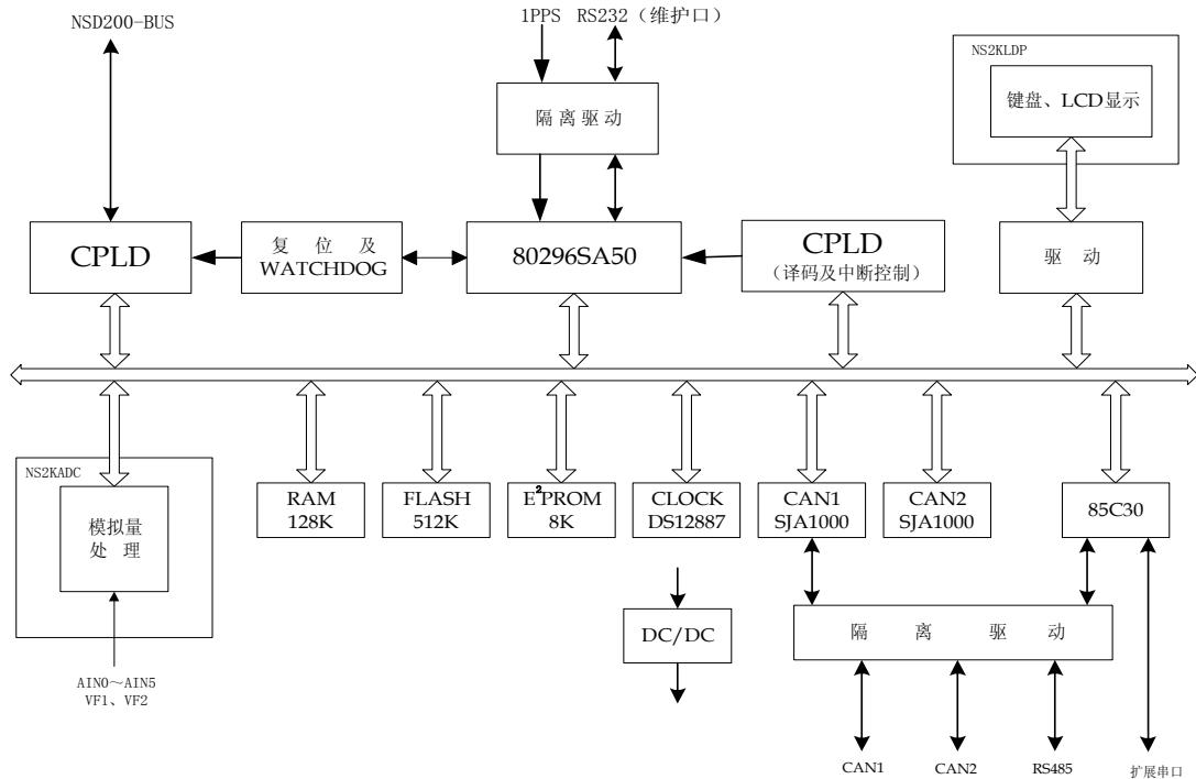
图 3.3 NSD200 系列通用测控装置 CPU 模块原理框图
