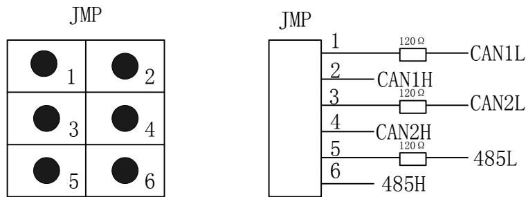
反射电阻用于防止由于通讯反射波造成的通讯不正常，常接于通讯网络的末端。
