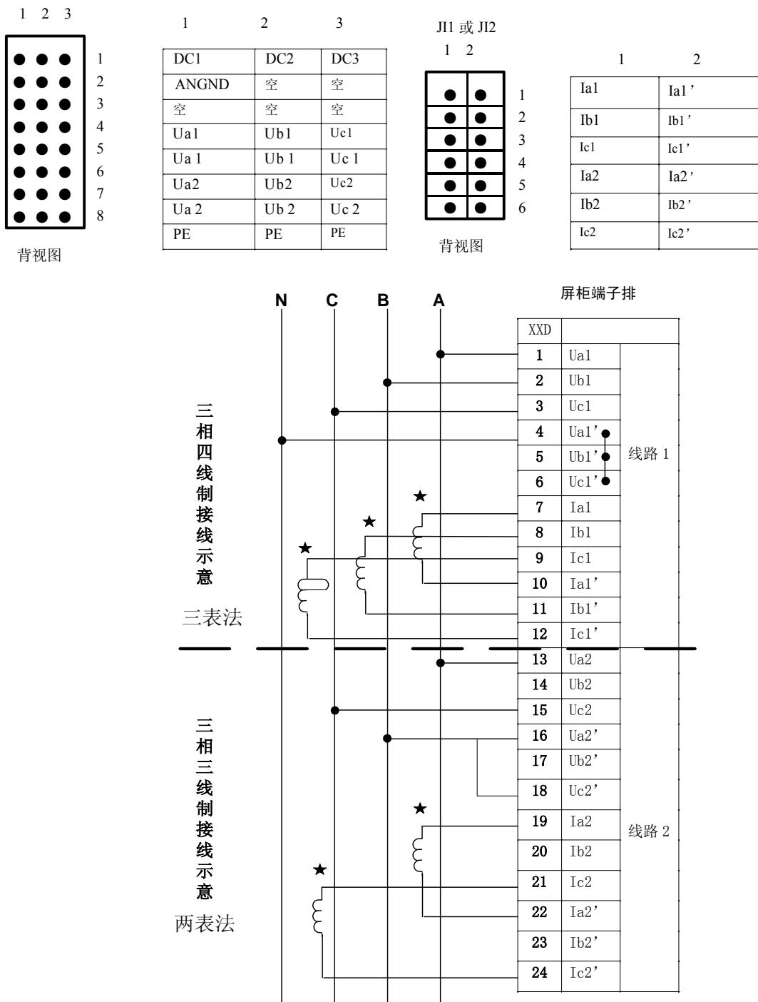
图 6.11 AC2A 模块端子定义
