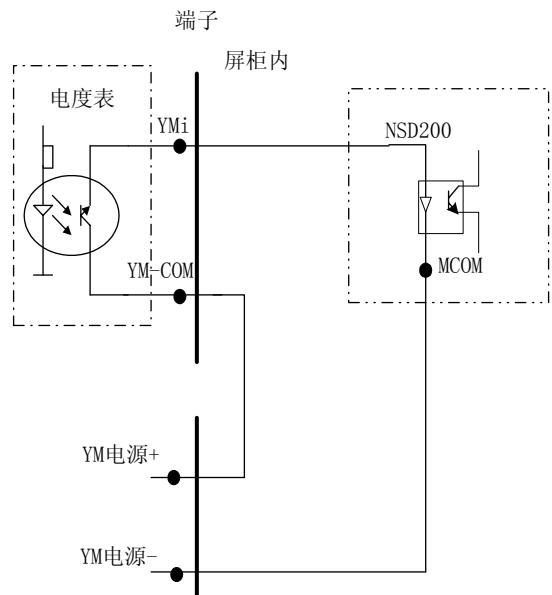
无源遥脉接点接线示意图
