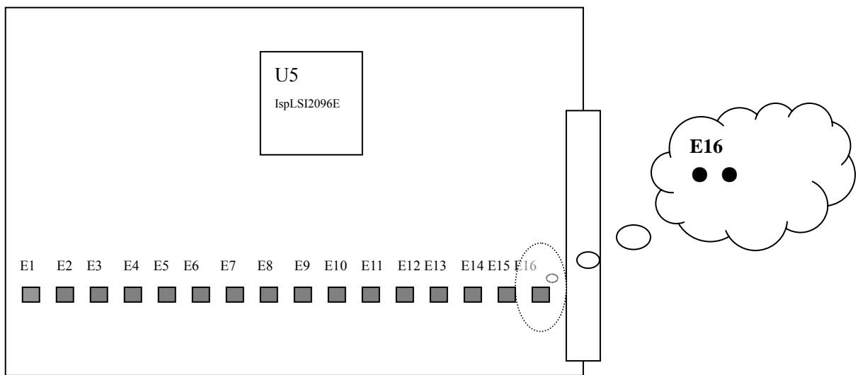
图 6.17 DI16A/PI16A 模块跳线位置图
