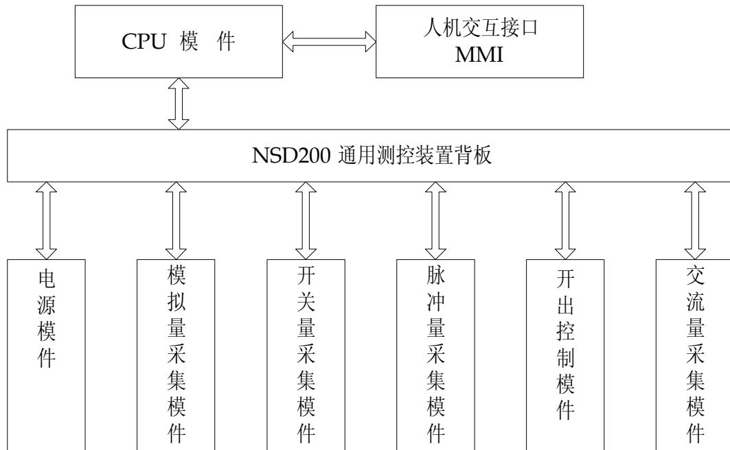
图 3.1 NSD200 系列通用测控装置原理框图
