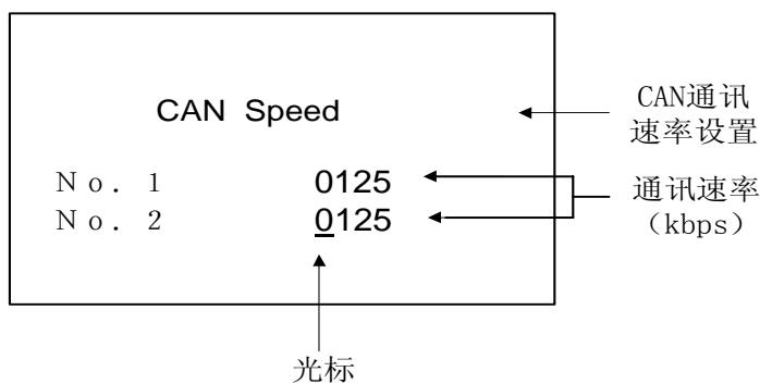
图 7.30 CAN 通讯速率设置界面
