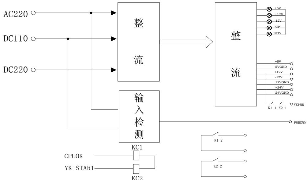
图 3.2 NSD200 系列通用测控装置电源模块原理框图
