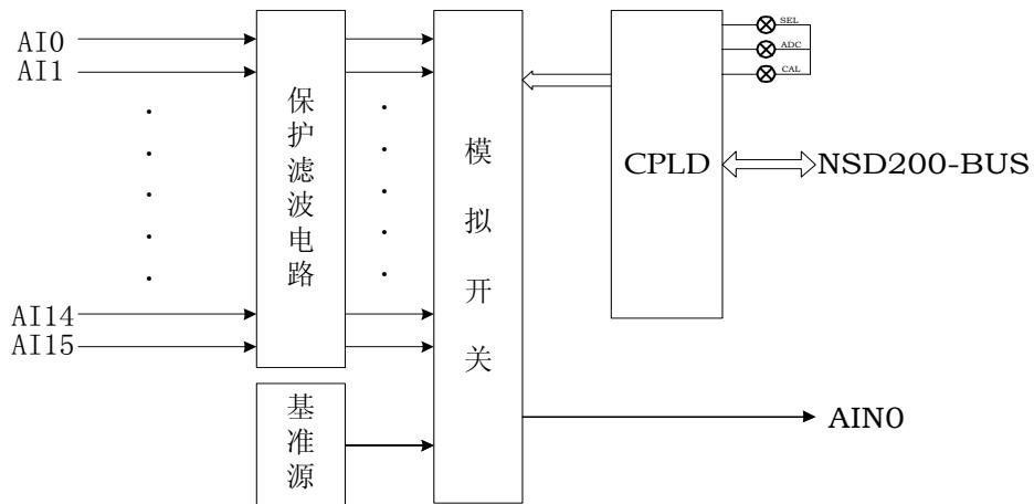
图 3.6 NSD200 系列通用测控装置 AI16 模块原理框图
