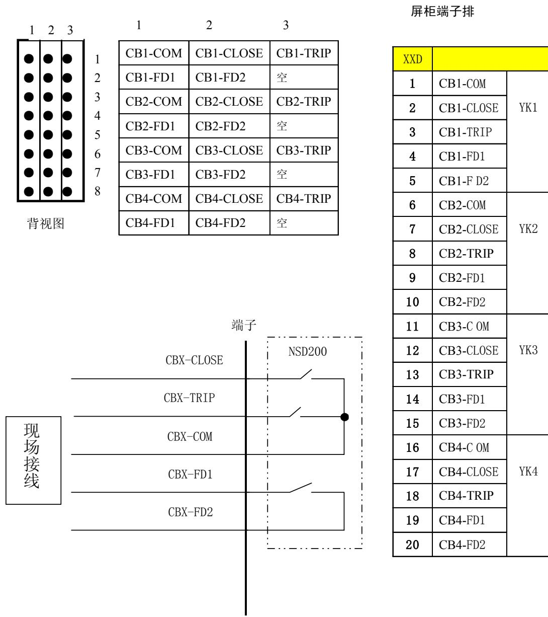
图 6.10 D04A 模块端子定义
