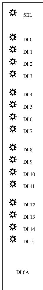
图 6.22 DI16A 模件面板指示灯图示
