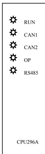
图 6.20 CPU296A/B 模块面板指示灯图示
