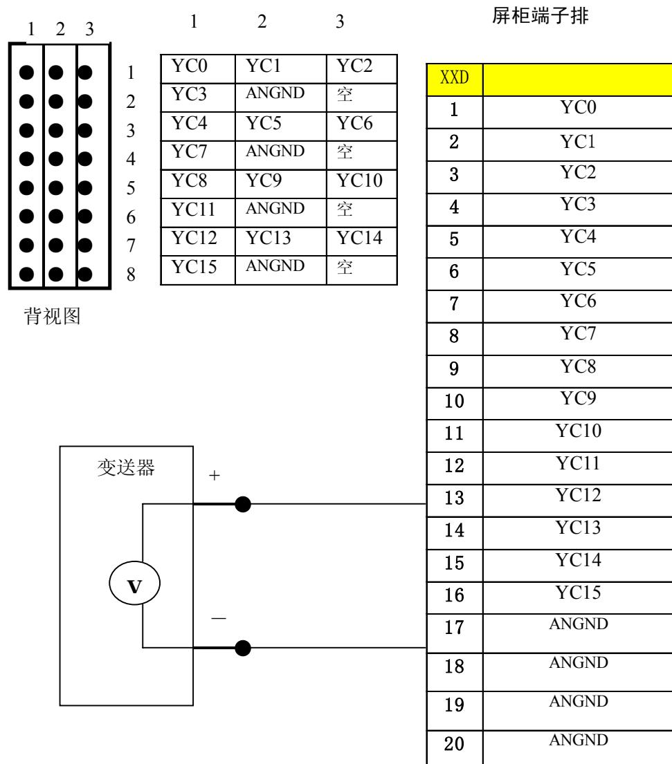
图 6.9 AI16A 模块端子定义
