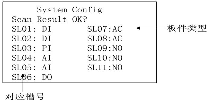
图 7.23 系统板件参数设置界面
