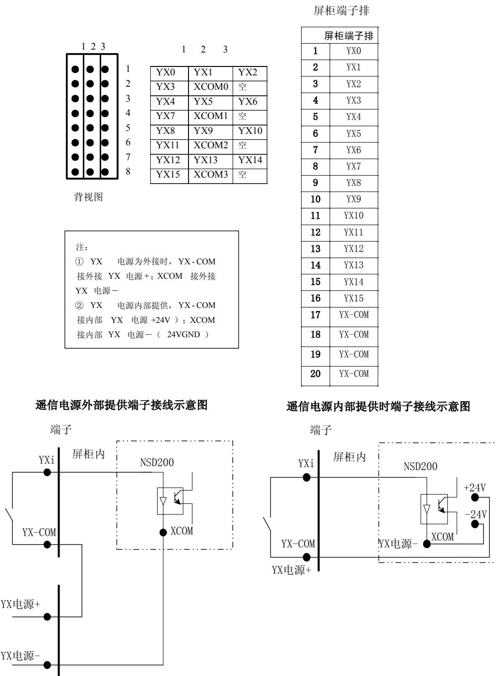
图 6.7 DI16A 模块端子定义
