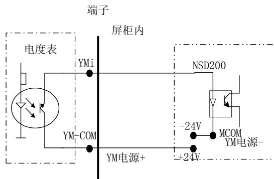
图 6.8 PI16A 模块端子定义
