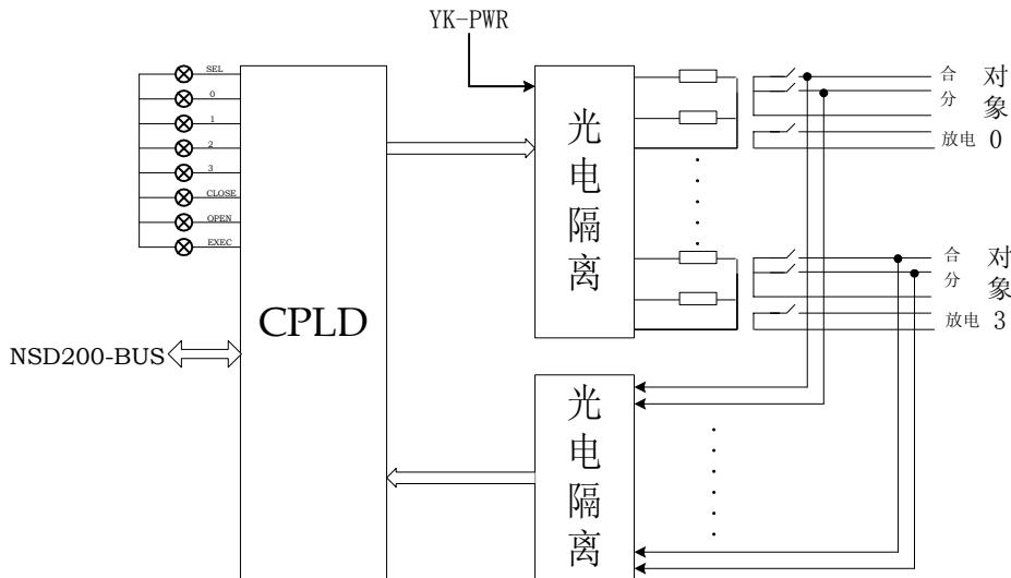
图 3.7 NSD200 系列通用测控装置 D04A 模件原理框图
