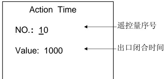
图 7.29 控制输出接点闭合时间设置界面
