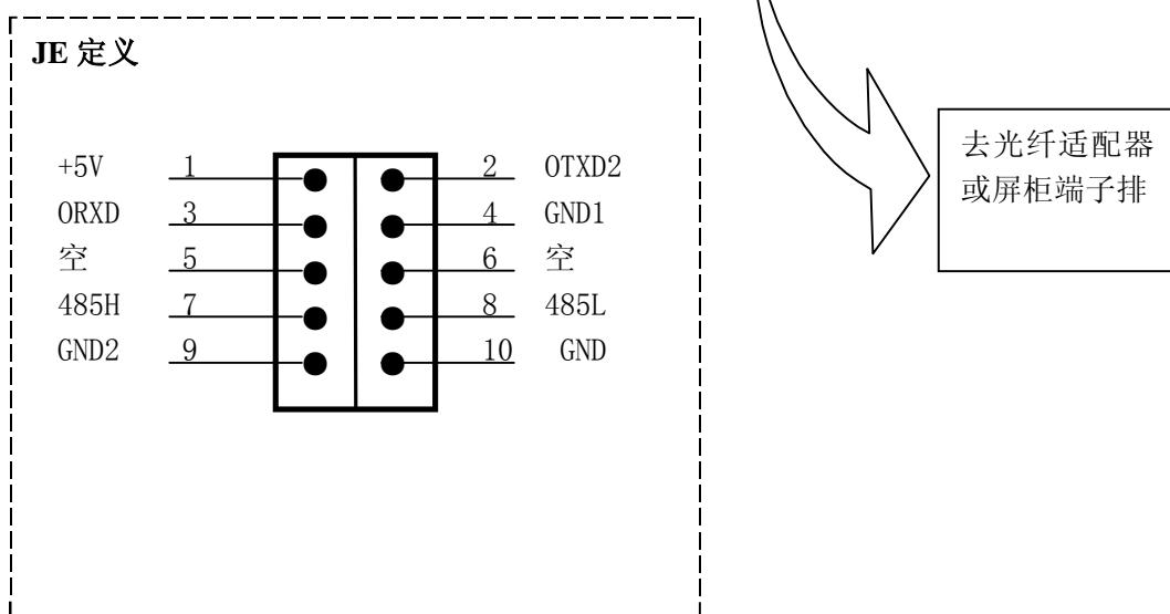
图 6.5 RS485 串口通讯接线图
