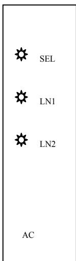
图 6.21 AC2A 模块面板指示灯图示
