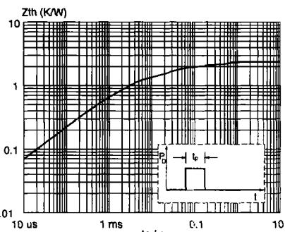
*Fig.11. Transient thermal impedance; per diode;
