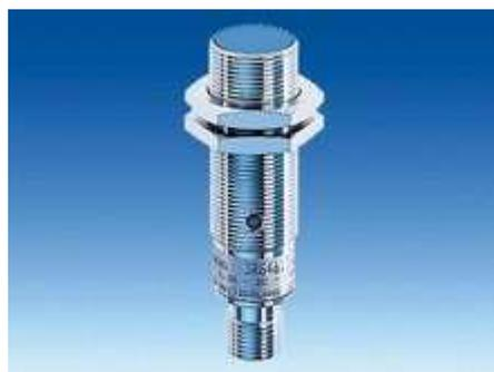
БЕСКОНТАКТНЫЙ ИНДУКТИВНЫЙ ДАТЧИК ПОЛОЖЕНИЯ VERO M18, DC 15...34V, SN=8MM, ВЫСТУПАЮЩИЙ, НО, 25МА, 2-ПРОВОДНЫЙ, НИКЕЛИРОВАННАЯ ЛАТУНЬ, С ШТЕКЕРОМ M12, IP67
