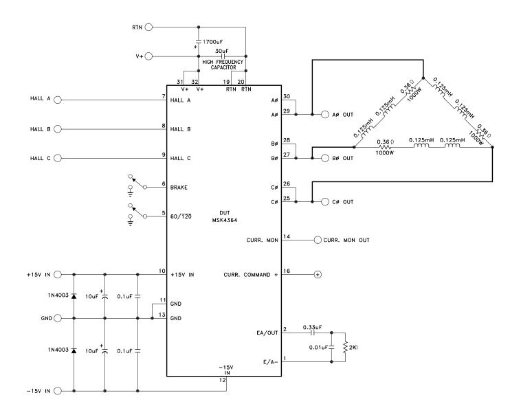
TYPICAL TEST SCHEMATIC
