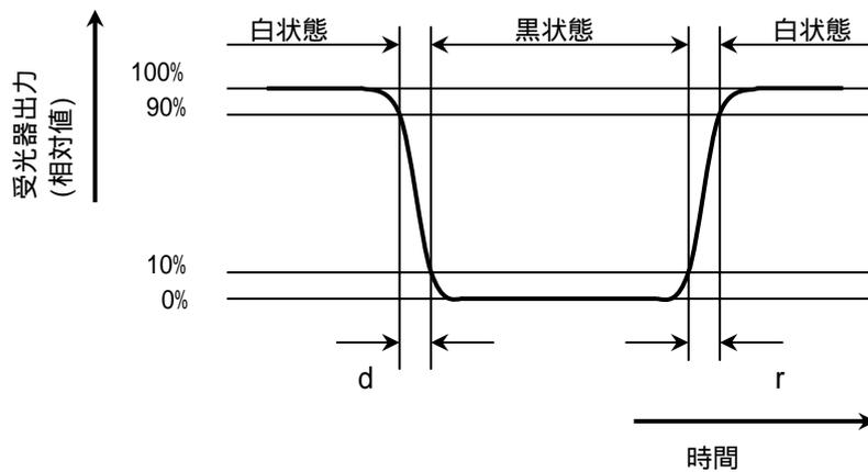
下図に示すように白及び黒状態となる信号を入力し、その時の受光器出力の時間変化にて定義します。
