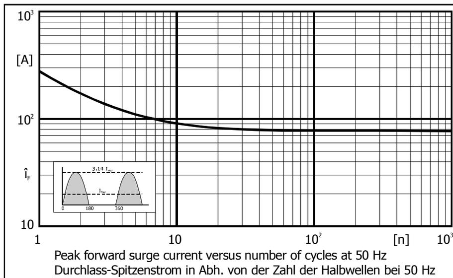
1 Tested with pulses  $t_p = 100\text{ ms}$  – Gemessen mit Impulsen  $t_p = 100\text{ ms}$
