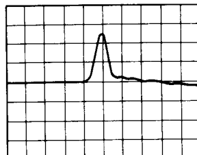
H-Axis : 20ns/div V-Axis : 50mA/div
