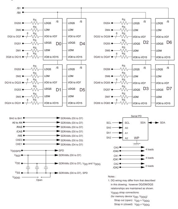
Remarks 1. The value of all resistors of DQs, DQSs, DM/DQSs is 22  $\Omega.\pm\,5\%$
