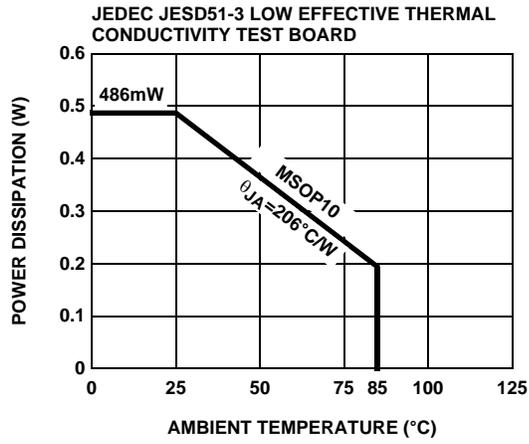
FIGURE 25. PACKAGE POWER DISSIPATION vs AMBIENT TEMPERATURE
