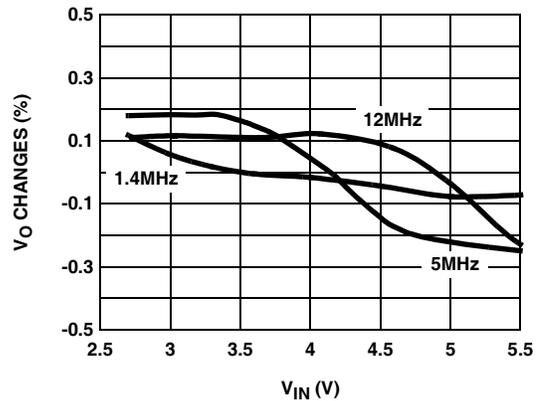
FIGURE 12. LINE REGULATION @ 500mA (PWM MODE)
