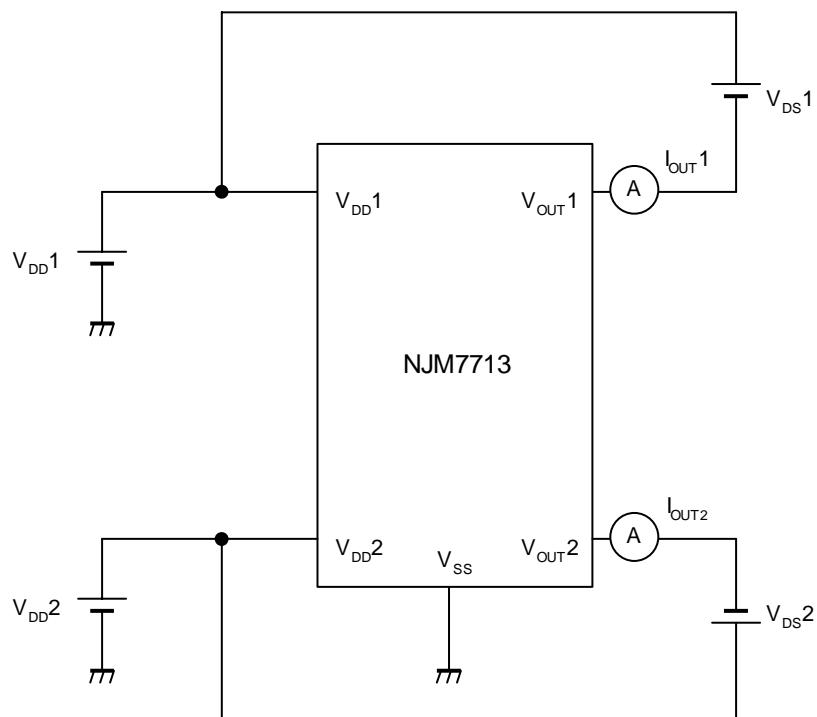
④ MINIMUM OPERATING VOLTAGE TEST CIRCUIT
