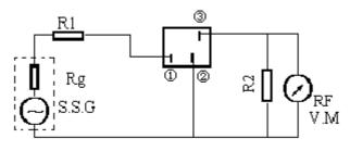
Rg+R1=R2=輸入輸出阻抗 Input/Output Impedance
